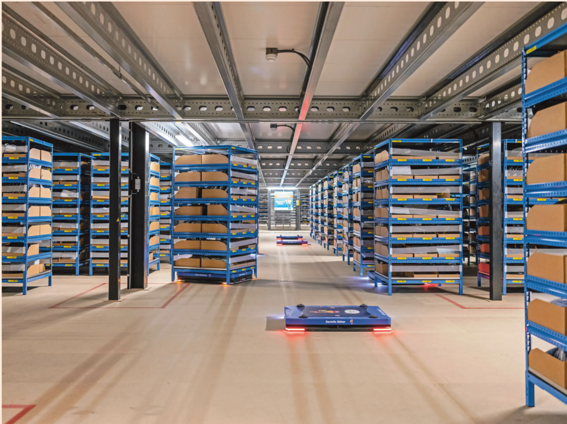
De 'cobots' van Montapacking hebben geleerd de structuur van de vloer te herkennen en weten precies waar ze zijn en waar ze naar toe moeten. Foto's: Roger Cremers voor het FD.
